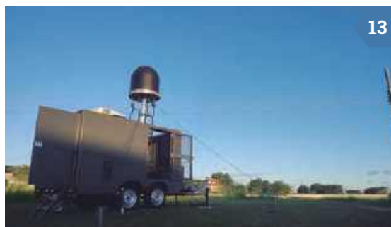
Figuras 13 MAGE Veicular instalado em viatura tipo shelter. Operação em campo
