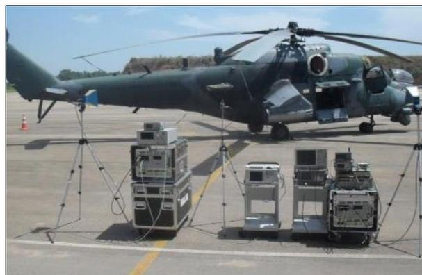
Fig. 15 – Atividade de campo dos alunos do PPGAO e do CEAAE, com instrumentos do LabGE para Avaliação Operacional do “Radar Warning Receiver” (RWR) da aeronave AH-2 [1]
