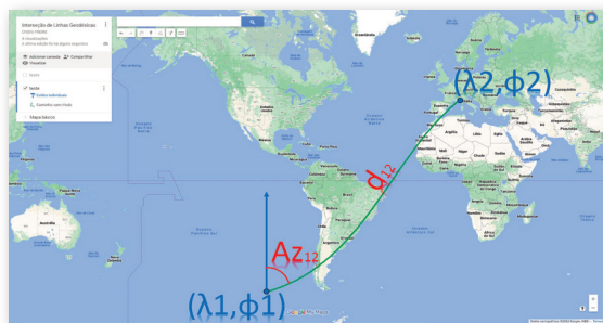
Figura 2 – solução inversa para linhas geodésicas no elipsoide. Fonte: elaboração própria.
