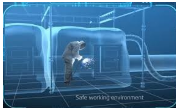
Figura 3 - ilustração de câmara hiperbárica, soldagem a seco
