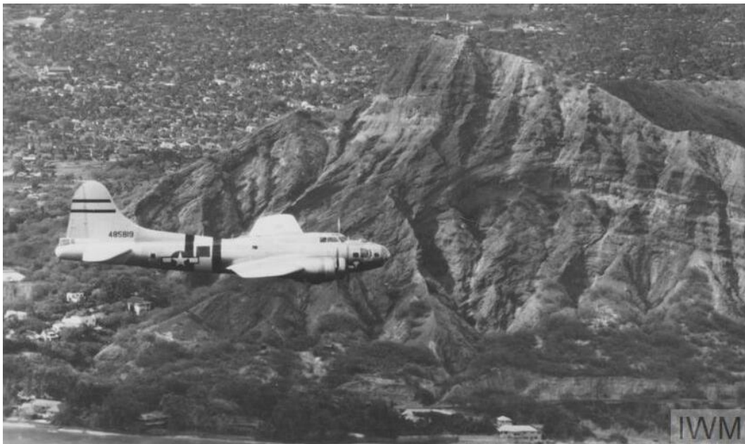
Figura 20: Protótipo de B-17 adaptado como VANT em voo de teste no Havai, em 1946
