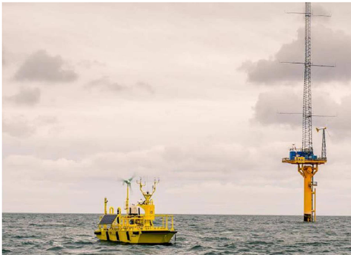
Figura 15 – Sensor LIDAR flutuante instalado.
