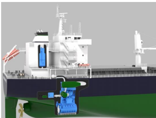
Figura 12. Depurador instalado em navio.
