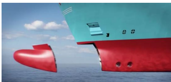
Figura 10. Redesenho do arco bulboso para reduzir a resistência.
