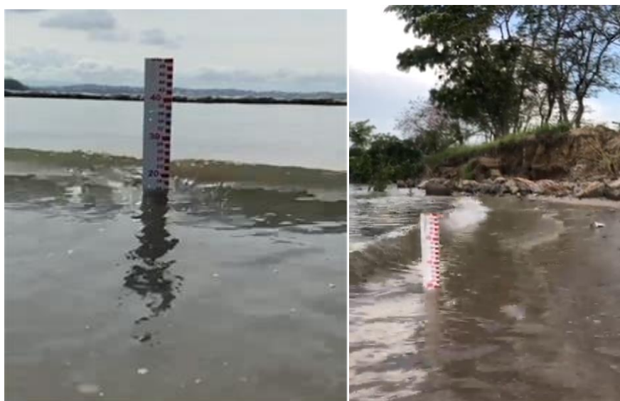
Figura 13 – Ajuste de metodologia para medição de onda (Fonte: acervo pessoal, agosto/2023).
