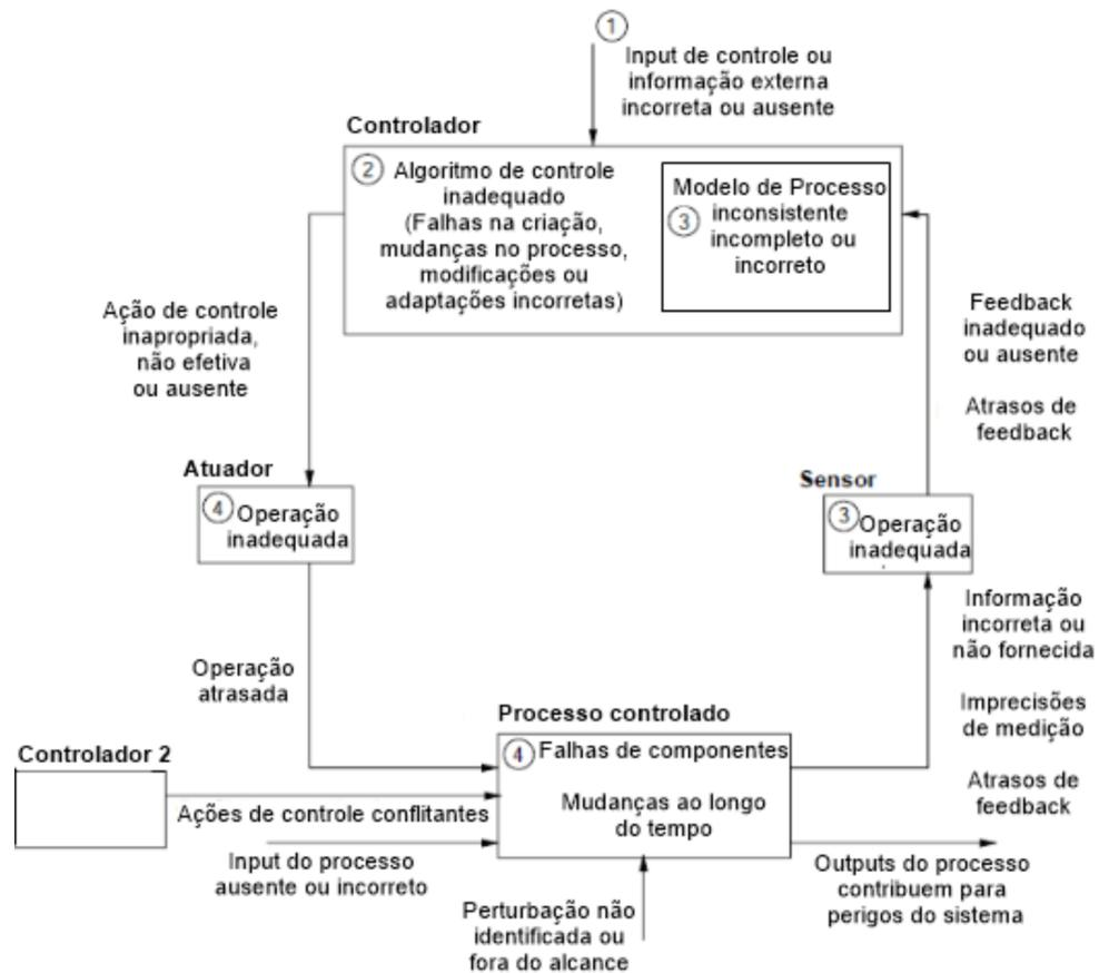
Figura 2.4: Tipos principais de falhas na EHCS
