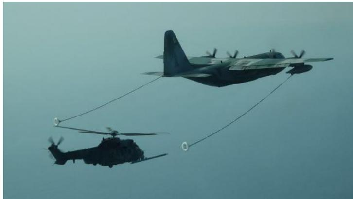
FIGURA 2.1 – Aeronave *receiver* realizando procedimento de aproximação para acoplamento com o cesto (FORÇA AÉREA BRASILEIRA, 2020).
