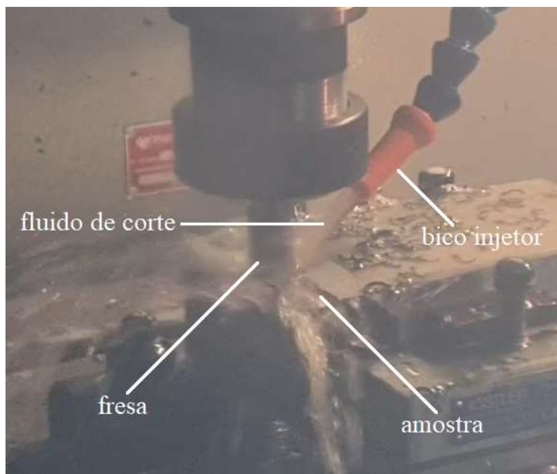
Figura 3.5 – Ensaio de fresamento com aplicação de fluido de corte no modo jorro.
