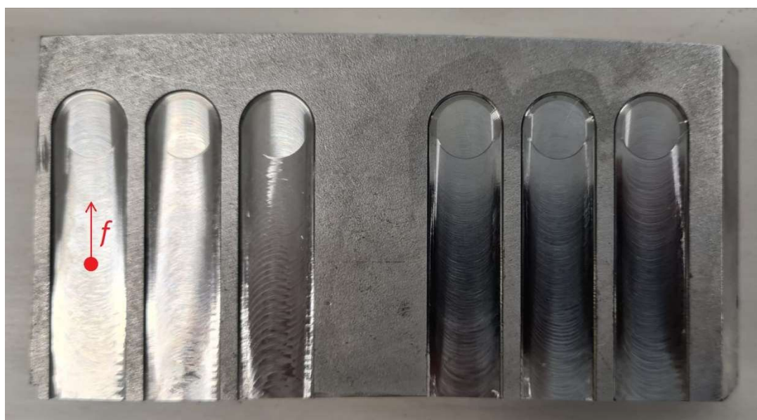
Figura 3.12 – Amostra com indicação dos locais de medição das tensões residuais.
