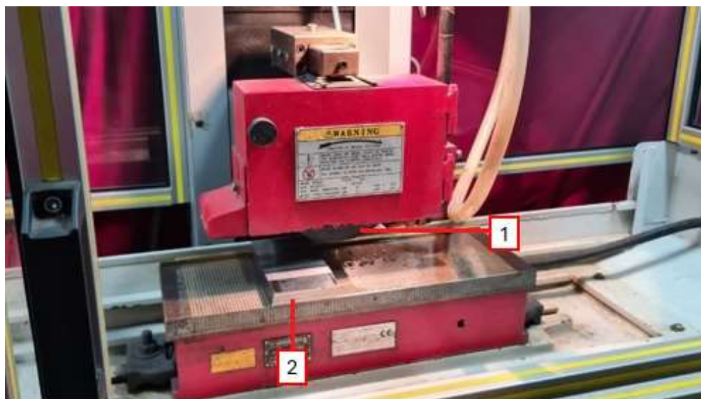
Figura 3.9 – Amostra fixada na retificadora: 1) Rebolo, 2) Amostra retificada.
