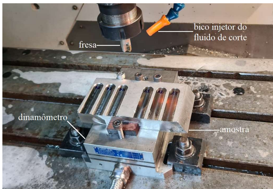
Figura 3.8 – Amostra na fresadora após o fresamento nas condições 2 e 3.
