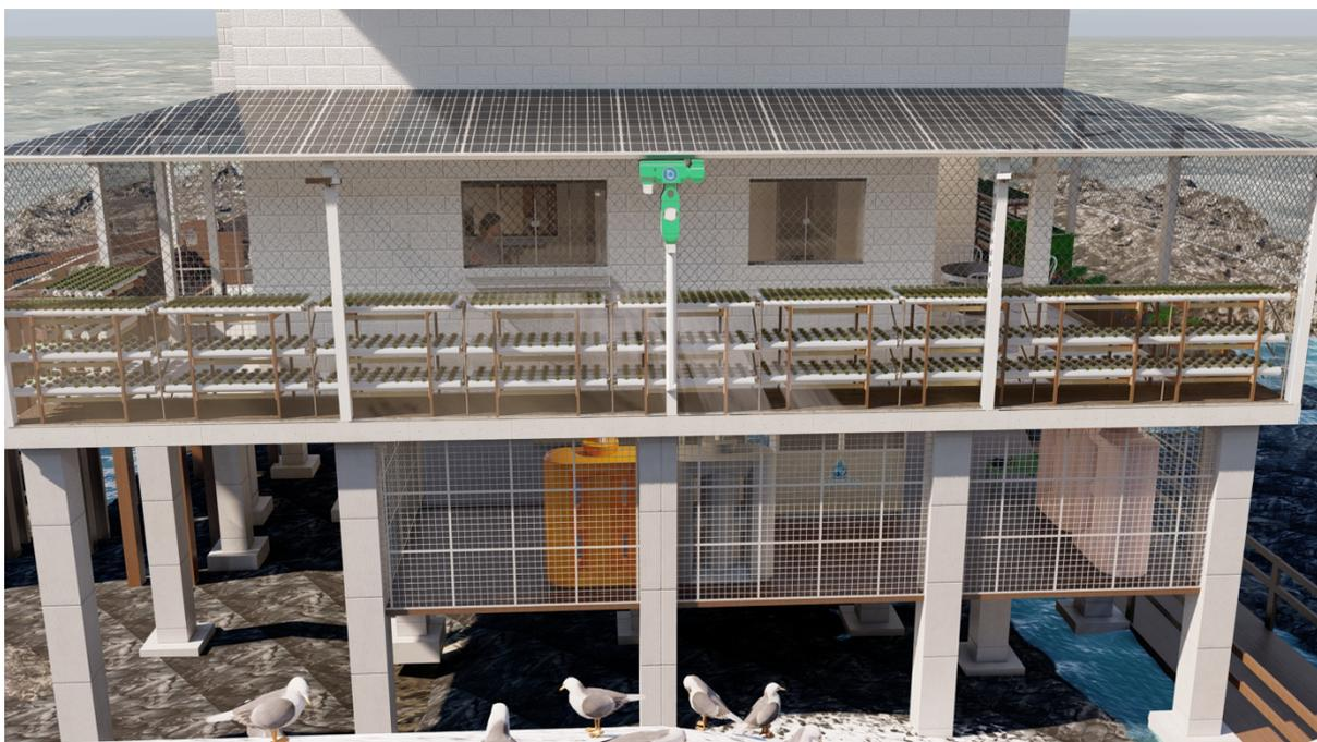
Vista da iluminação externa com abastecimento independente de energia – com luz de LED, energia solar portátil, com sensor de claridade (acende automaticamente ao escurecer e apaga ao clarear o dia)
