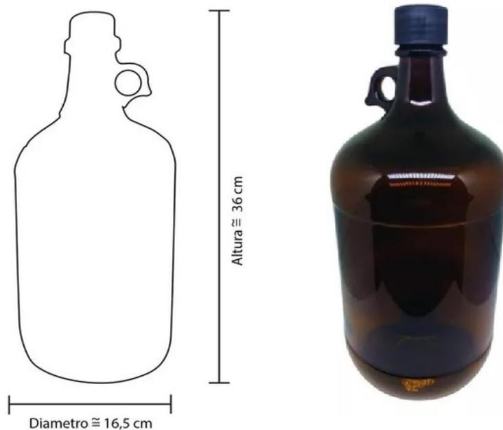
De modo a alcançar maior similaridade entre as amostras e as condições reais de ambiente de exposição marítima dos combustíveis armazenados a bordo de tanque nos navios, o frasco teve uma entrada e saída de ar confeccionada com um cano de abertura de 3/16 polegadas para
