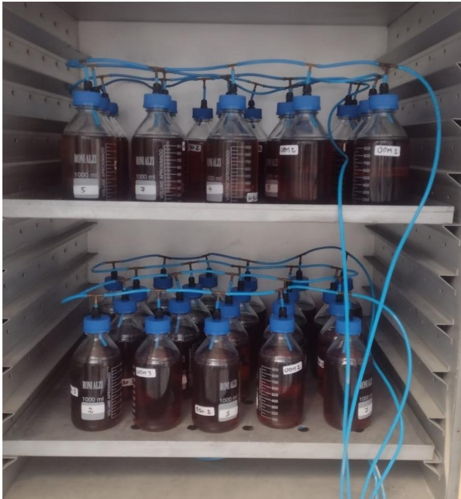
A temperatura da estufa foi checada inicialmente utilizando um termômetro a laser industrial da marca Smart Tools, de precisão de  $\pm 1,5^{\circ}\text{C}$ . Considerando a faixa de precisão do equipamento, todos os pontos que foram avaliados dentro da estufa encontravam-se na faixa de temperatura prevista.
